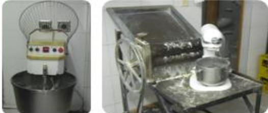
Los órganos móviles de las máquinas, motores, transmisiones, piezas salientes y cualquier otro elemento o dispositivo mecánico que presente peligro para los trabajadores, deben ser provistos de la adecuada protección por medio de guardas.
