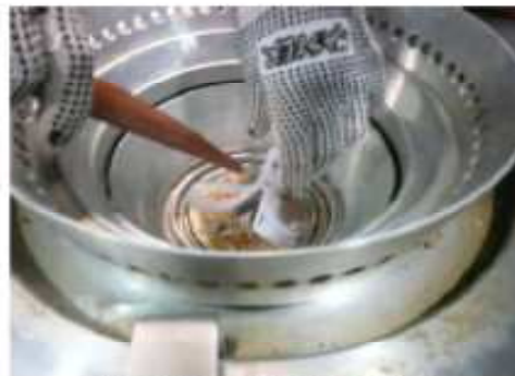
Figura 3. Limpiando boquilla del dado
