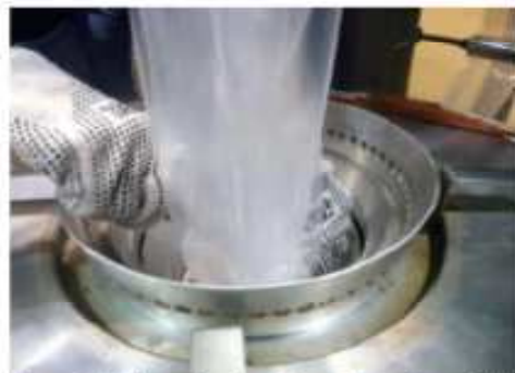
Figura 4. Unión película preformada con la película guía.
