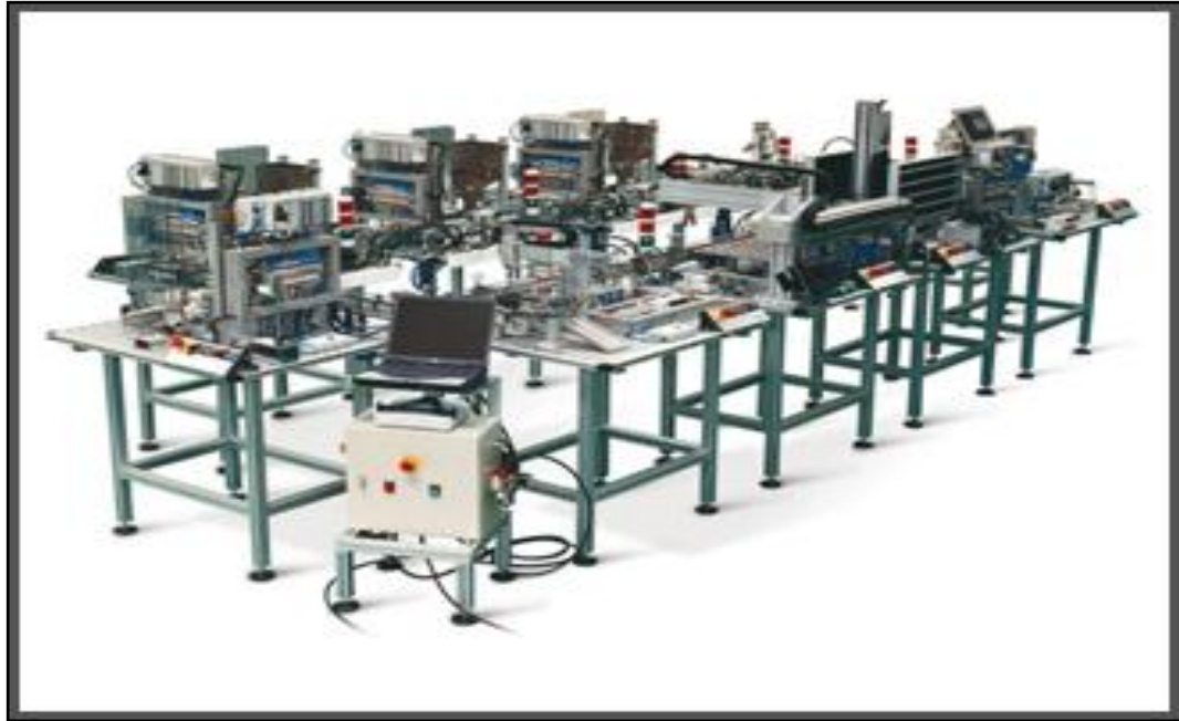
Figura 8 Celda de Manufactura HAS200
