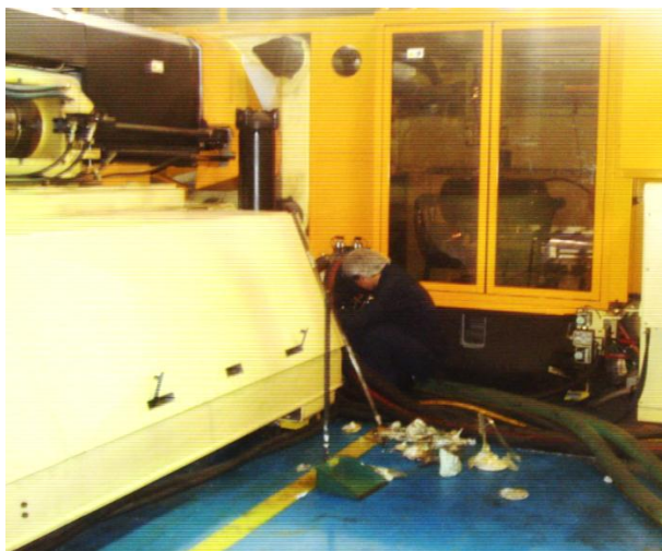
Figura 49. Limpieza de punto crítico en una inyectora.
