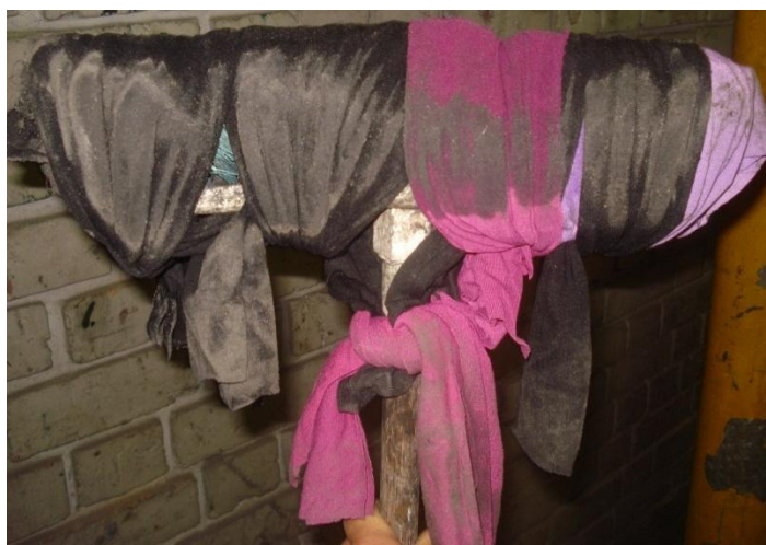
Figura 50. Implemento de limpieza después de ser usado en el techo de una inyectora Husky.
