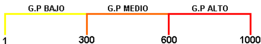
FIGURA 14. Escala de Grado de Peligrosidad 59
