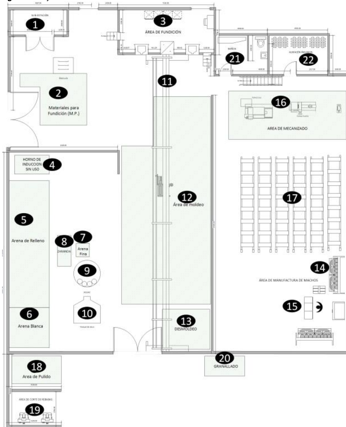
Figura 10 Layout estado actual de METALMEC S.A.S.
