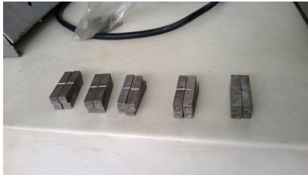
FIGURA 13 PROBETAS DE IMPACTO FABRICADAS BAJO LA NORMA: ASTM E23 STANDARD TEST METHODS FOR NOTCHED BAR IMPACT TESTING OF METALLIC MATERIALS
