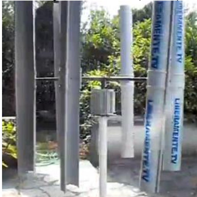
Figura 15. Aerogenerador M29 de 6 palas en polímero
