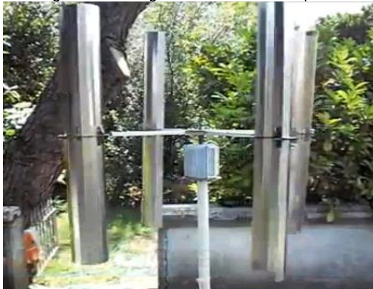
Figura 14. Aerogenerador M33 con 4 palas
