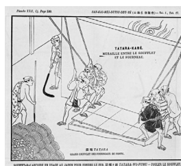
San-kai-mei-butsu-dzu-yé. Vol. I, Tab. 17. Soufflet-balancoire en usage au Japon pour fondre le fer. Tataro-wo-fumu - fouler le soufflet.
