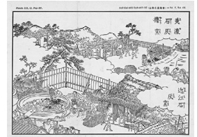
San-kai-mei-san-dzu-yé. Vol. V, Tab. III. Les fours a chaux au Japon (Prov. Omi et Mino), et le travail des chauffourniers.
