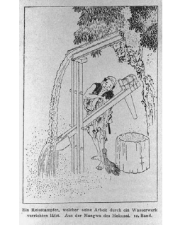
Ein Reisstampfer, welcher seine Arbeit durch ein Wasserwerk verrichten lässt. 水力で仕事を果たさせる米つき道具[杵]
