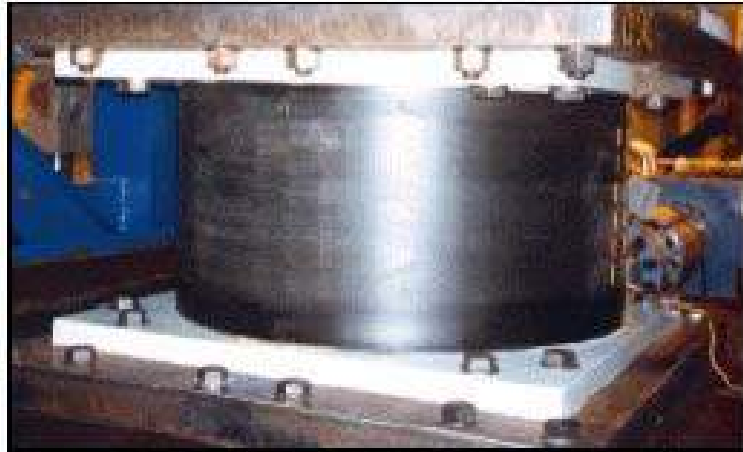
Figura 7. Aislador elastomérico de caucho natural
