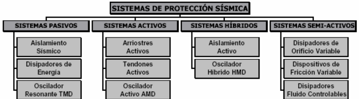
Figura 6. Clasificación de los sistemas de control estructural sísmicos. El AMS aparece en la primera columna con sus siglas en ingles (TMD).
