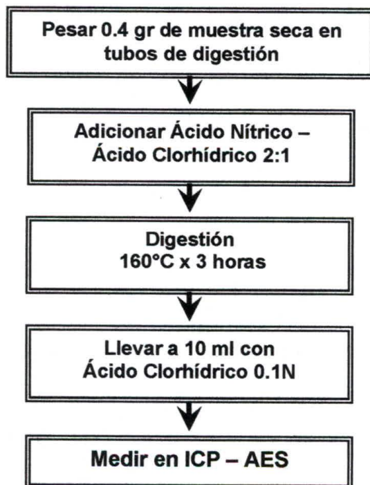
FIGURA 8. Metodología utilizada para la extracción total de metales pesados en órganos de R. mangle (Modificado de INVEMAR, 2002; Garay et al. , 2003a).
