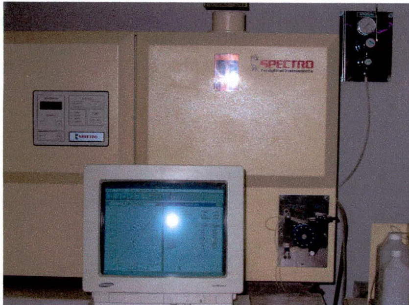
FIGURA 9. Espectrofotómetro de Emisión Atómica usado en el proceso de medición de metales pesados.
