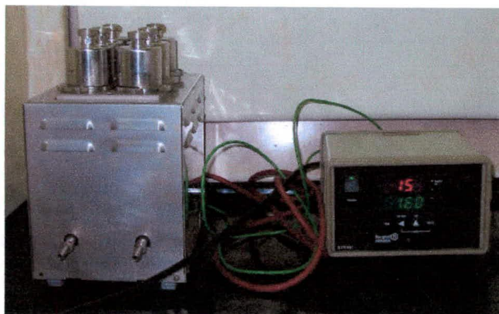
FIGURA 7. Proceso de digestión a presión del material vegetal.
