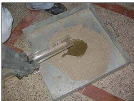
Foto 9. Adición de agua a la mezcla de suelo-cemento.
