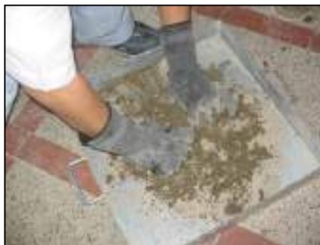
Foto 10. Mezcla del suelo, cemento y agua.
