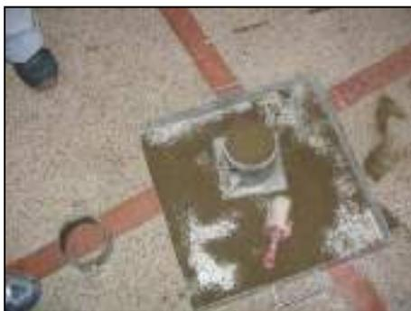
Foto 11. Muestra compacta con próctor modificado.
