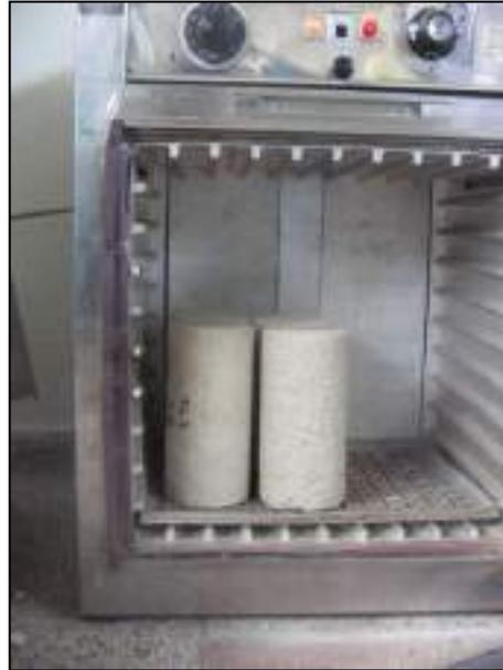
Foto 14. Especímen durante ensayos de durabilidad.
