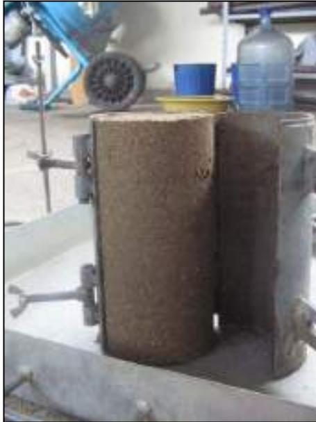
Foto 13. Espécimen para ensayo de durabilidad recién compactado.
