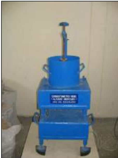
*Foto 1. Máquina Vibratoria Vebe Test, empleada para compactar las probetas por vibrado.*
