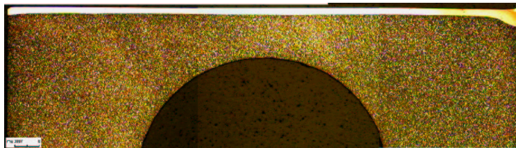
Abb. 3: Längsschliff (Versuch mit Bohrung parallel zur Oberfläche (2 mm tief), C100).
