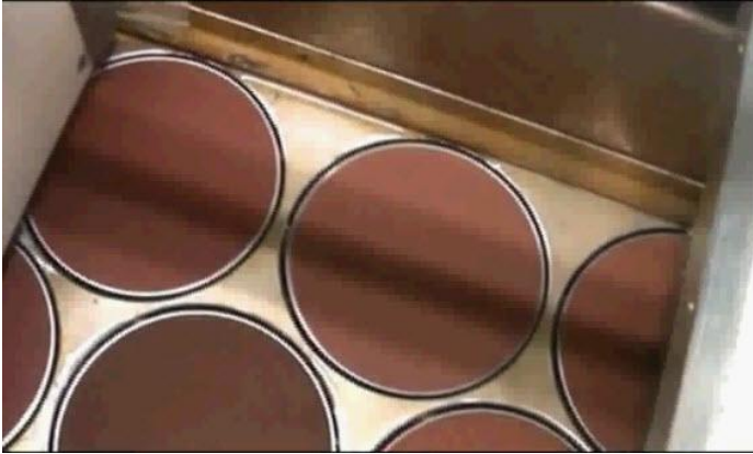
Gambar 1.11. Alat Pengupas dengan Metode Abrasive ( Abrasion Peeling )
