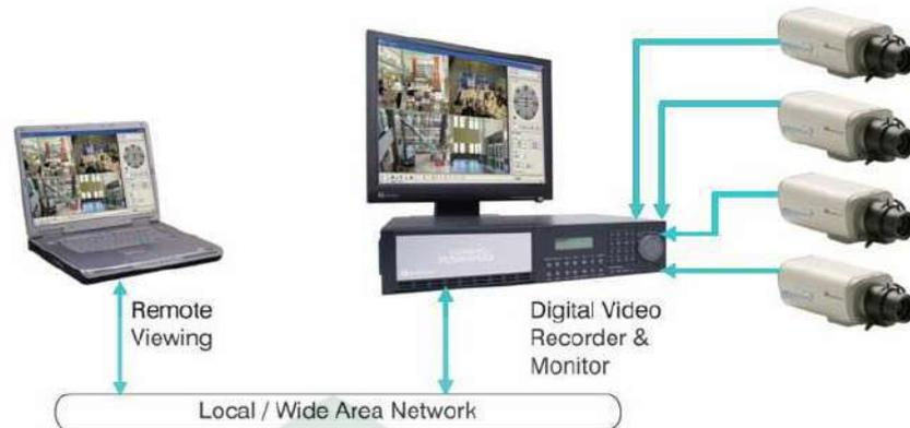
Gambar III.41. Sistem jaringan CCTV sederhana
