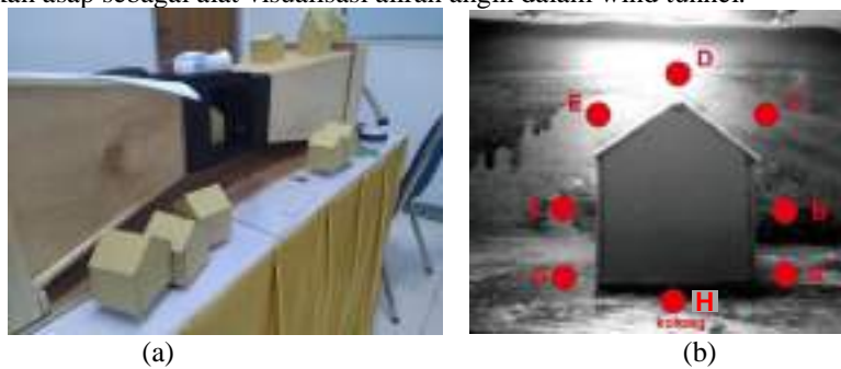
Gambar 7: (a) Alat dan model uji wind tunnel; (b) Perletakan titik sensor kecepatan angin alat wind tunnel
