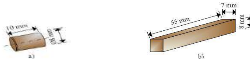
Gambar 5. Spesimen MMCs: a) Bentuk penampang silinder, b) Bentuk balok
