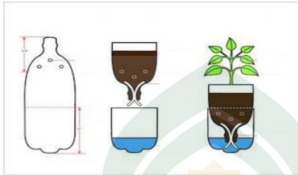
Gambar 2.1 : Cara bertanam hidroponik sistem wick (Nurwahyuni, 2015).
