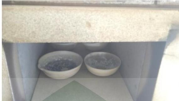
Gambar 3.6: proses sintering (pembakaran) sampel
