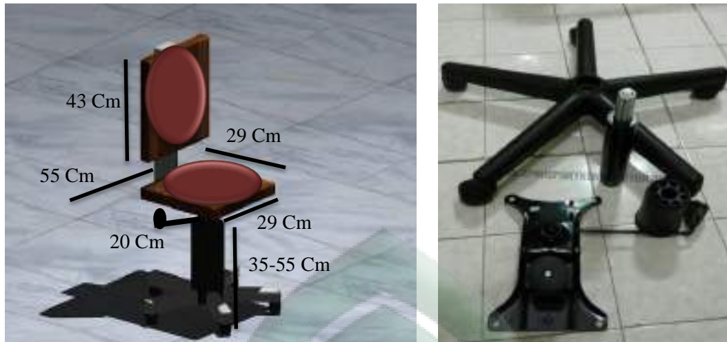
Gambar 4.4. Tiga Dimensi Kursi Kerja dan Contoh Baut Ring
