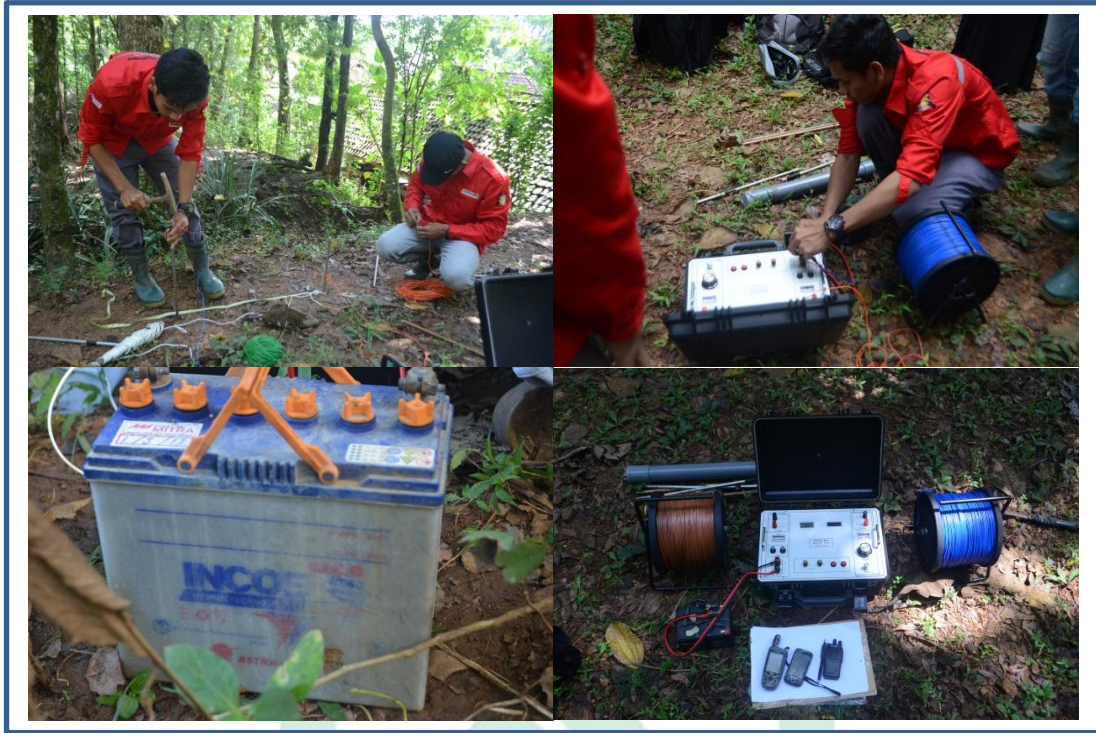
Proses pemasangan alat geolistrik dan elektroda
