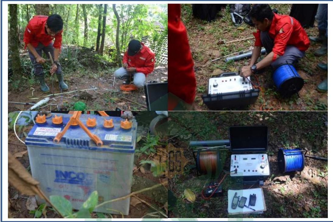
Proses pemasangan alat geolistrik dan elektroda
