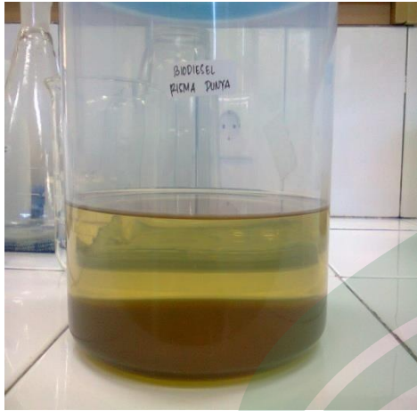
a. campuran minyak kelapa+metanol +NaOH, setelah didiamkan selama 24 Jam (pengendapan dan pemisahan).
