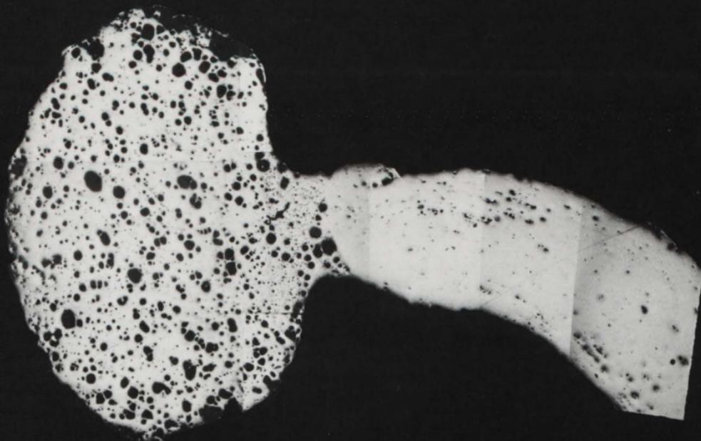
partes se aprecia con mayor contraste al ser atacada con cianuro de potasio y persulfato de amonio (Figuras 2a y 2b). La estructura más fina de la soldadura puede entonces ser diferenciada visualmente de la esfera fundida debido a que este reactivo acentúa el contraste entre aleaciones con diferentes contenidos de oro.
