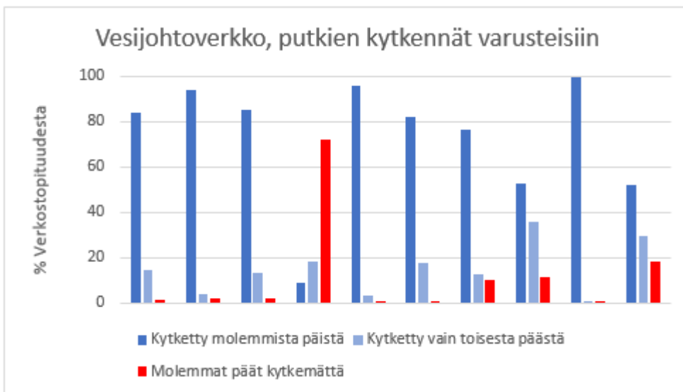
Kuva 3.9. Vesijohtojen kytkenät varusteisiin.
