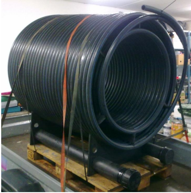
Kuva 3.1. Vesistölämmönvaihtimen prototyyppi. Rakennelman alla putkistot, joilla ankkurointi tapahtuu. (kuva: Anne Mäkiranta)
