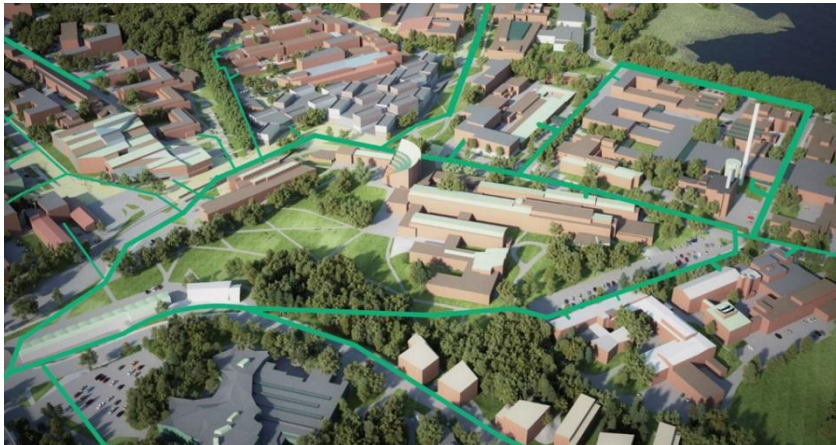
Kuva 6.2. Aalto-yliopistokiinteistöt Oy:n Energiaomavarainen Otaniemi 2030 -projektissa tutkittiin lämpöverkon merkitystä hajautetun lämmöntuotannon kannalta. Tutkimuksessa verrattiin yhteensä 11,3 MW:n maalämpökaivojen käyttöä 29 tai vaihtoehtoisesti 10 rakennuksessa. Laskelman perusteella 10 rakennuksen järjestelmiä voitaisiin hyödyntää vuodessa 19000 MWh enemmän, mikäli kaikki rakennukset pystyisivät käyttämään niitä lämpöverkon välityksellä. (Koikkalainen A., 2015) Kuva: Aalto-yliopistokiinteistöt Oy.
