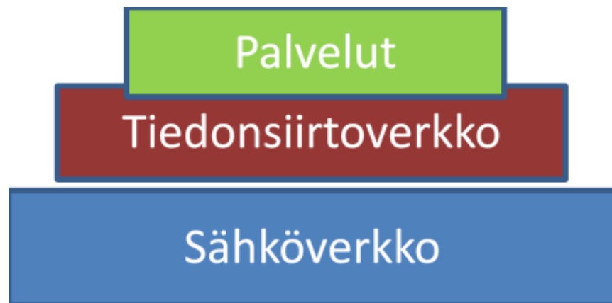
Kuva 4. Kriittisen infrastruktuurin pelkistetty rakenne.
