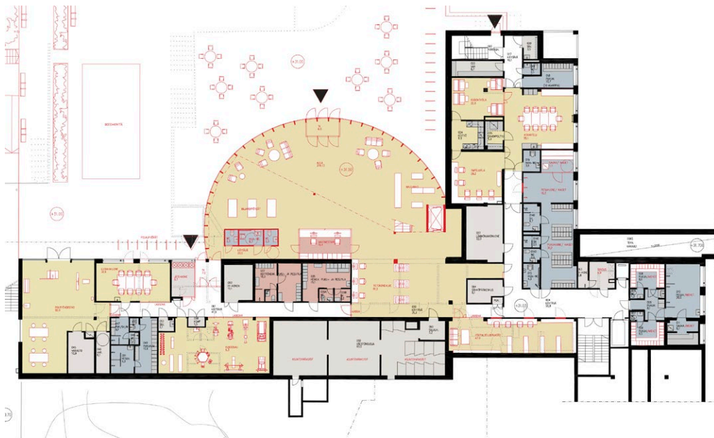
Kuva 45. Simonkylän palvelukeskuksen uusi aulatila tekee sisäänkäynnin esteettömäksi ja korjausrakentamalla ajanmukaistetut harrastetilat ovat hyvin saavutettavissa. (Ryhänen, 2016 luonnos).
