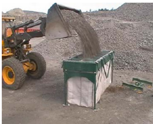
Kuva 2. Alfa-Bag -suursäkkien täyttö täyttökehikon avulla. (Lähde: Alfa Bag Oy Ab)
