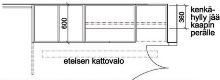
Kuva 11. Esimerkki eteiskalusteratkaisusta, jossa kaappien edessä oleva valoramppi valaisee kaapin sisätiloja.
