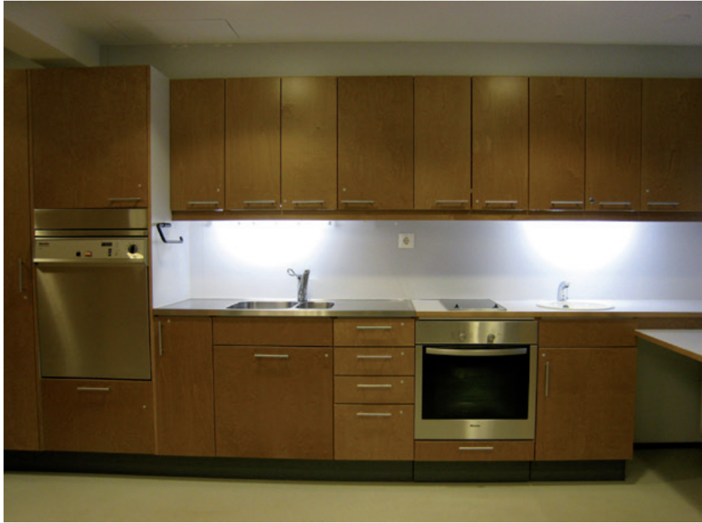
Kuva 26. Ryhmäkodin keittiö, jossa astianpesukone on sijoitettu ergonomisesti oikein kalusteeseen 400 mm lattiasta ja uuni on turvallisesti alhaalla. Valolistan taakse sijoitettu työtasovalaisin antaa tasaisen taustavalon työskentelyalueelle.
