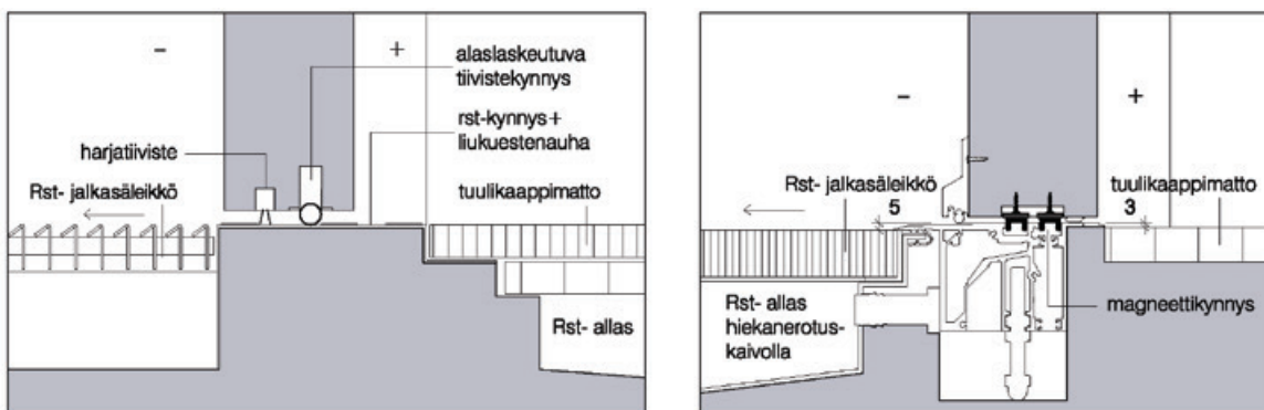
Kuva 22. Koti kaikille -hankkeessa kehitetyt kynnyksettömät sisäänkäyntioviratkaisut jalkasäleikköineen.
