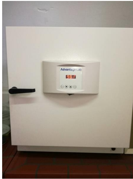
Slika 13 Sušionik zagrijan na 98 °C
