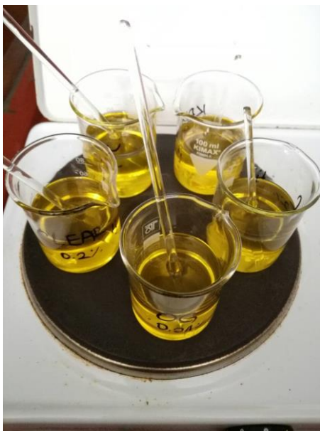
Slika 11 Zagrijavanje i miješanje uzoraka sa i bez dodanih antioksidanasa
