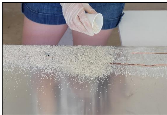
Slika 164. Posipanje vapnenačkog drobljenca na svjež nanos epoksidnog ljepila.
