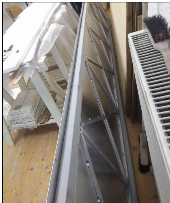
Slika 156. Poledina pokretnog nosača od aluminijskih letvica s pričvršćenom privremenom ukrutom od čeličnih greda.
