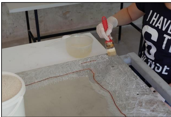
Slika 163. Nanošenje epoksidnog ljepila Epocon veza SN za lijepljenje vapnenačkog drobljenca.
