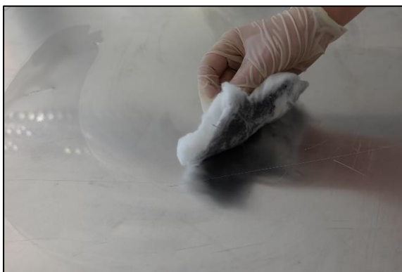
Slika 161. Uklanjanje masnoće i prašine s aluminijske ploče acetonom.
