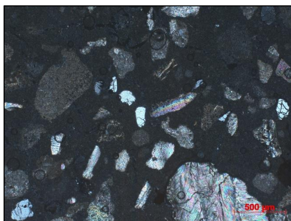
Slika 16. Mikrofotografija ispoliranog tankog presjeka uzorka 3. Transmisijsko svjetlo, ukršteni polari.
