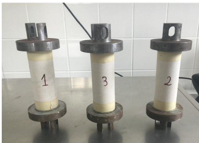
Slika 6-2 Uzorci cementirani na metalne kapice
