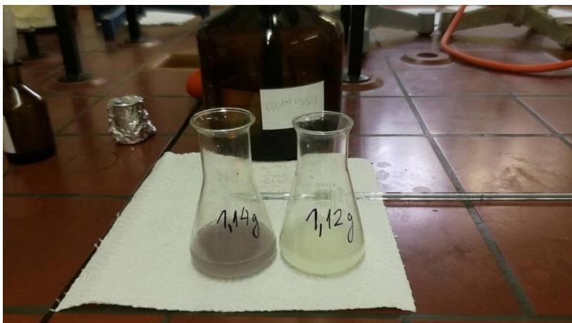
Slika 6 Određivanje Pbr u uzorcima ulja
