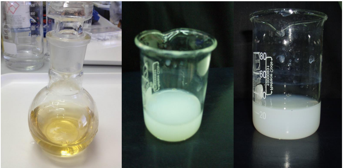
Slika 4. Otopine nanočestica srebra (lijevo), cerijevog(IV) oksida (sredina) i titanijeva dioksida (desno) (fotografije iz osobne arhive, 2013).
