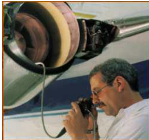
Slika 7. Moderna vizualna kontrola fiberoskopom [3]
