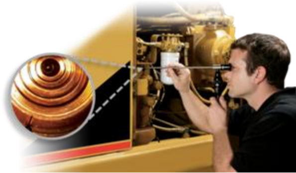
Slika 6. Vizualna kontrola uz pomoć Boreskopa [9]
