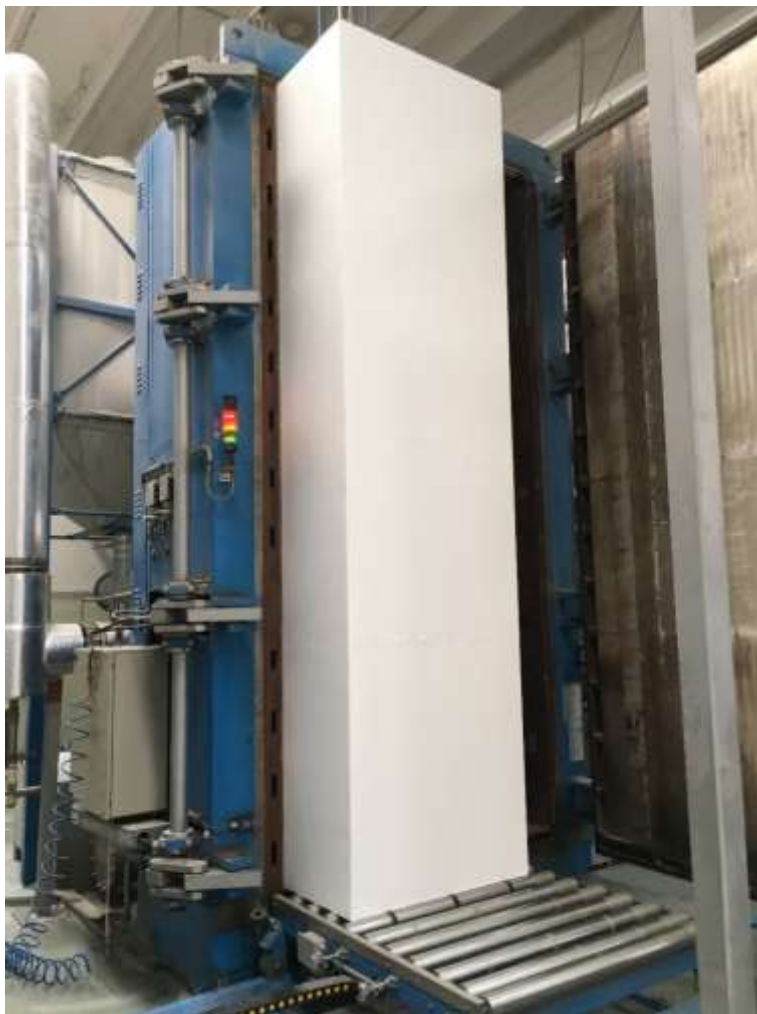
Slika 4.12 Blok forma izlazi iz kalupa
