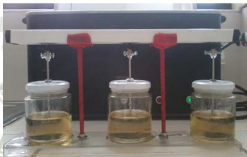
Figura 18. Sistema con agitación constante para la determinación del efecto de la temperatura en la producción de EPS.
