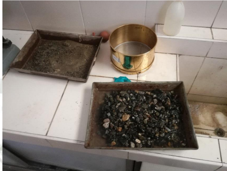
Figura 4-19: Agregado grueso lavado para determinar el porcentaje de finos pasantes de la malla N° 200. Fuente: Elaboración y Formulación Propia.
