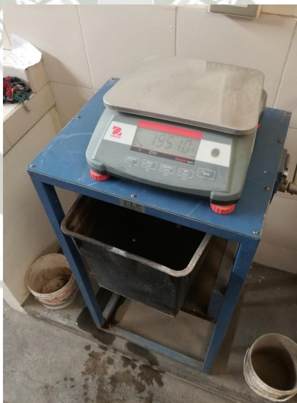
Figura 4-21: Balanza con agregado grueso sumergido para determinar su gravedad específica. Fuente: Elaboración y Formulación Propia.
