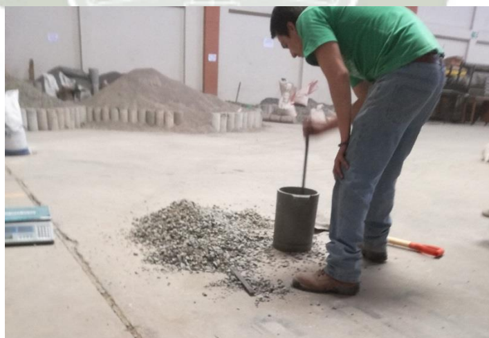
Figura 4-15: Varillado del agregado Grueso para halla el PUC. Fuente: Elaboración y Formulación Propia.
