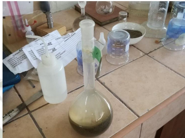
Figura 4-38: Picnometro con agua y 500 gr de agregado fino sss. Fuente: Elaboración y Formulación Propia.
