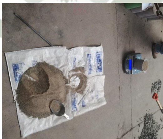
Figura 4-31: Equipo y herramientas para determinar el PUC y PUS del agregado fino. Fuente: Elaboración y Formulación Propia.
