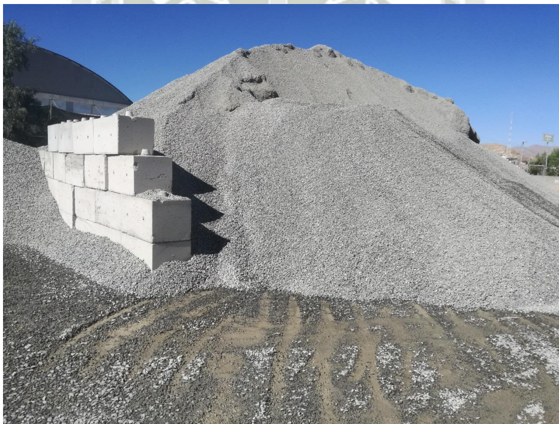
Figura 4-7: Agregado grueso huso 6-7, cantera La Poderosa. Fuente: Elaboración y Formulación Propia.
