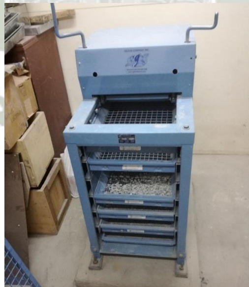
Figura 4-10: Tamizado del agregado grueso huso 67 cantera La Poderosa. Fuente: Elaboración y Formulación Propia.
