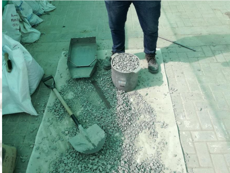
Figura 4-14: Ensayo para hallar el peso unitario Compactado Fuente: Elaboración y Formulación Propia.
