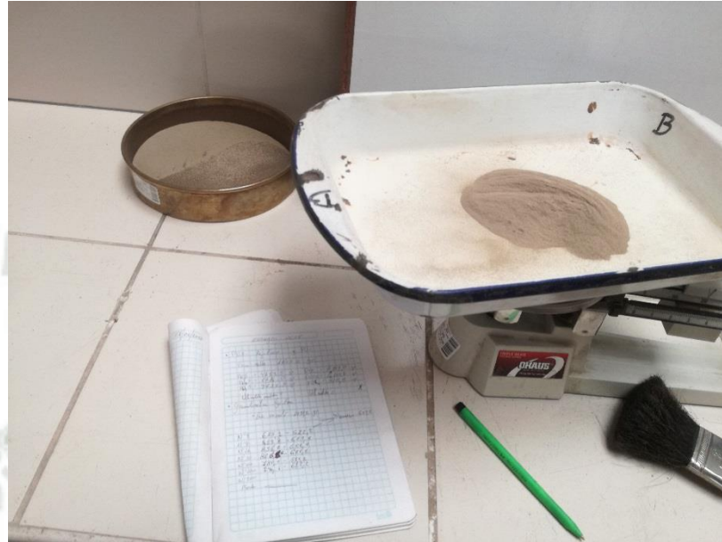
Figura 4-30: Pesado del material retenido en la malla N° 200 del tamizado del agregado fino para granulometría y módulo de fineza. Fuente: Elaboración y Formulación Propia.
