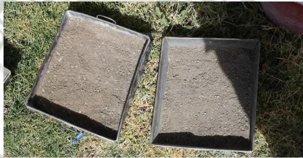
Figura 4-36: Agregado fino a la intemperie para llegar a su estado mojado superficialmente seco. Fuente: Elaboración y Formulación Propia.
