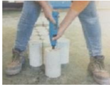
Figura 2-10 Procedimiento de ensayo de Martillo de Rebote. Fuente: Elaboración y formulación propia
