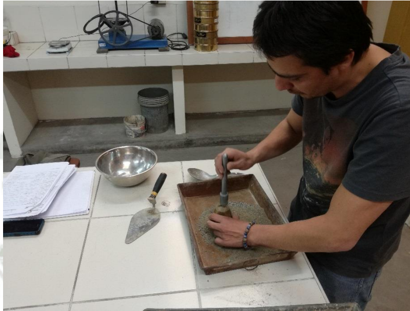
Figura 4-37: Ensayo del cono de compactación para determinar el estado superficialmente seco del agregado fino. Fuente: Elaboración y Formulación Propia.
