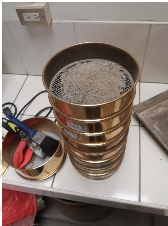
Figura 4-27: Agregado fino en tamices para hallar la granulometría. . Fuente: Elaboración y Formulación Propia.
