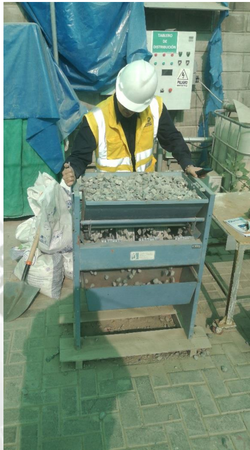
Figura 4-6: Procedimiento de Cuarteado de material para ensayos físicos. Fuente: Elaboración y Formulación Propia.
