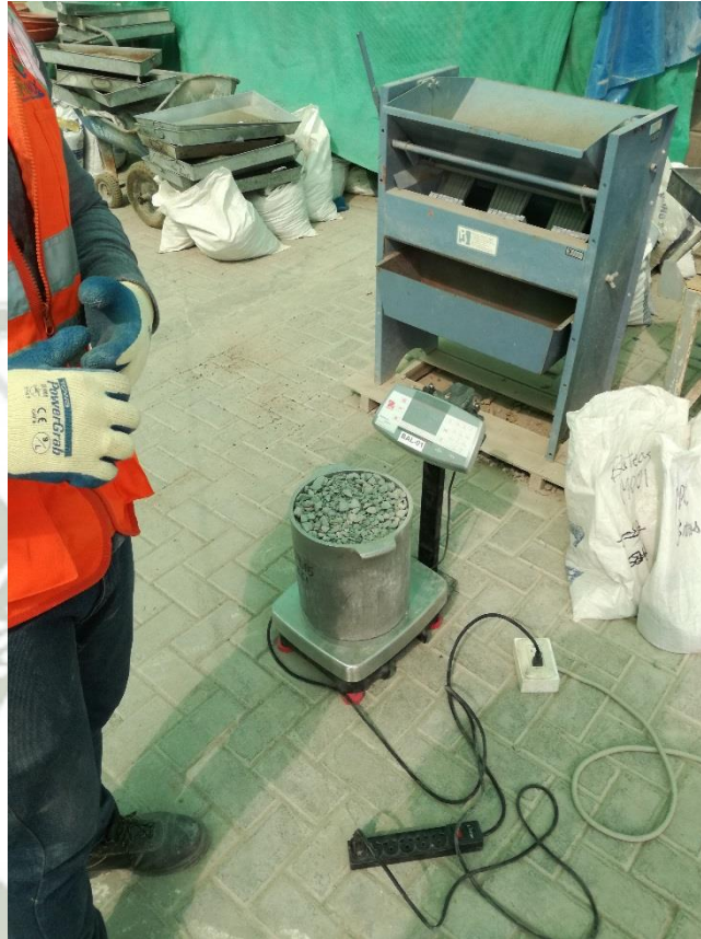
Figura 4-16: Pesado del molde de Peso unitario para determinar el PUS. Fuente: Elaboración y Formulación Propia.
