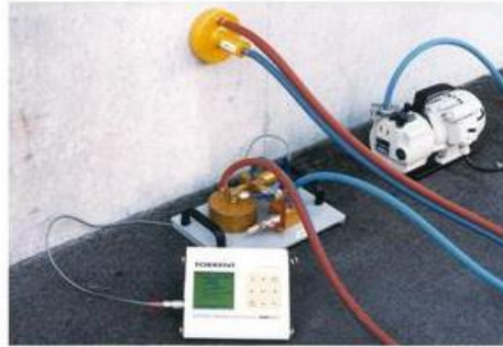
Figura 2-1: Equipo de Permeabilidad de TORRENT (Control de permeabilidad al aire) Fuente: (Daga SL Comercial de Ingenieria, s.f.)
