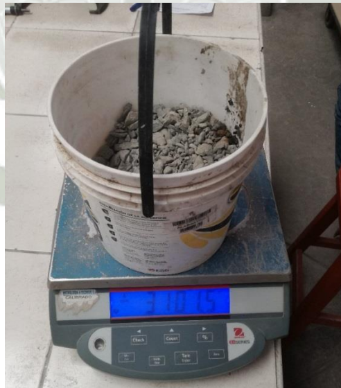
Figura 4-18: Pesado del agregado grueso con finos para determinar los finos pasantes la malla N° 200. Fuente: Elaboración y Formulación Propia.
