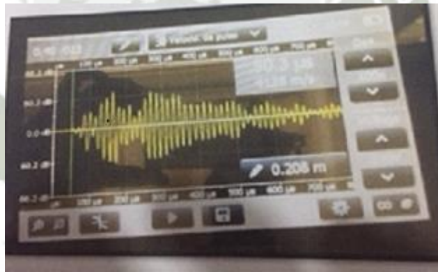
Figura 2-4 Pantalla de medidas de Equipo de Velocidad de Pulso. Fuente: Elaboración y formulación propia
