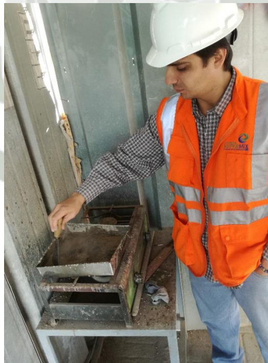
Figura 4-46: Secado del agregado para hallar el contenido de humedad. Fuente: Elaboración y Formulación propia
