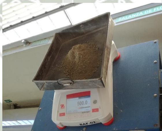
Figura 4-42: Muestra de agregado fino saturado superficialmente seco. Fuente: Elaboración y Formulación propia
