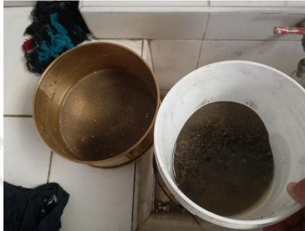
Figura 4-35: Lavado del agregado fino para hallar el porcentaje de material que pasa la malla N° 200. Fuente: Elaboración y Formulación Propia.
