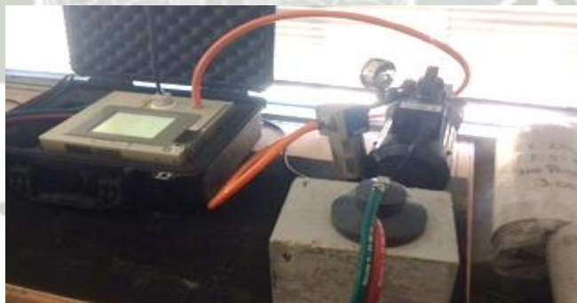
Figura 2-11: Procedimiento de ensayo de Permeabilidad al aire de TORRENT. Fuente: Elaboración y formulación propia
