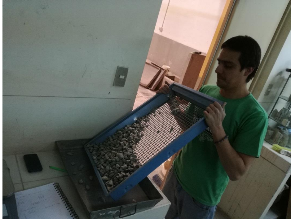
Figura 4-12: Extracción de material de agregado grueso retenido en el tamiz para hallar la granulometría y módulo de fineza Fuente: Elaboración y Formulación Propia.
