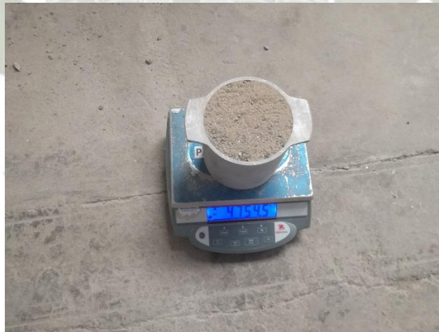
Figura 4-33: Pesado del agregado fino para hallar el PUS del agregado fino. . Fuente: Elaboración y Formulación Propia.
