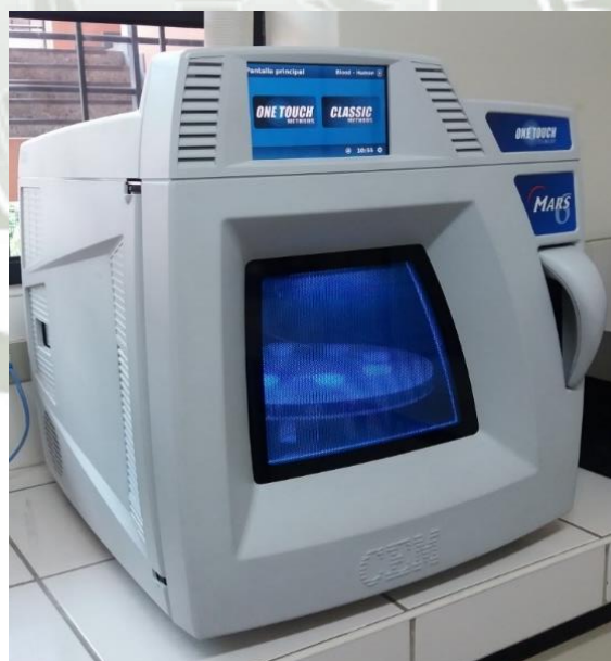
Fig.2.2. Equipo de microondas Mars 5 que se utilizó para digerir las muestras de Thunnus (atún)
