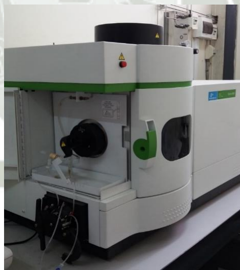
Fig. 2.3. Espectrofotómetro de Emisión Óptica inductivamente acoplado a Plasma (ICP-OES) Óptima 8000- Perking Elmer que se utilizó para cuantificar los metales traza en las muestras de Thunnus (atún)
