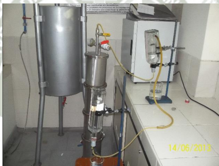
FIGURA 37. Construcción del sistema de medición de metano (%). Se observa en la figura la construcción del sistema utilizado para medir el porcentaje de metano en el biogás. Este método no convencional luego fue validado mediante una medición instrumental.
