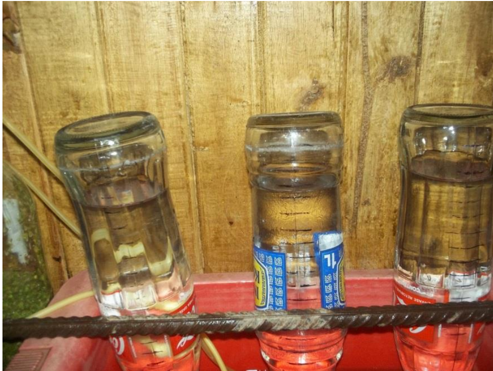
FIGURA N°7. En las botellas se pueden apreciar las medidas tomadas diariamente correspondientes al espacio creado por el desplazamiento del líquido.
