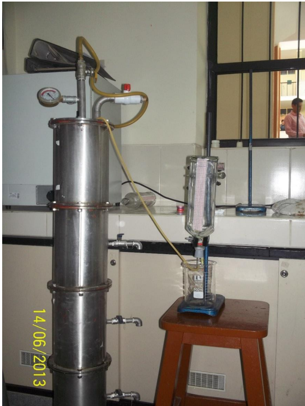
FIGURA N°9. Armado del método no convencional para la medición del porcentaje de metano.
