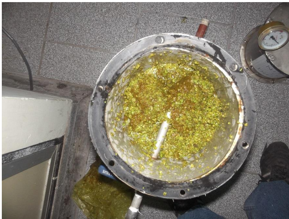
FIGURA N°5. Carga del bioreactor con la lenteja de agua.
