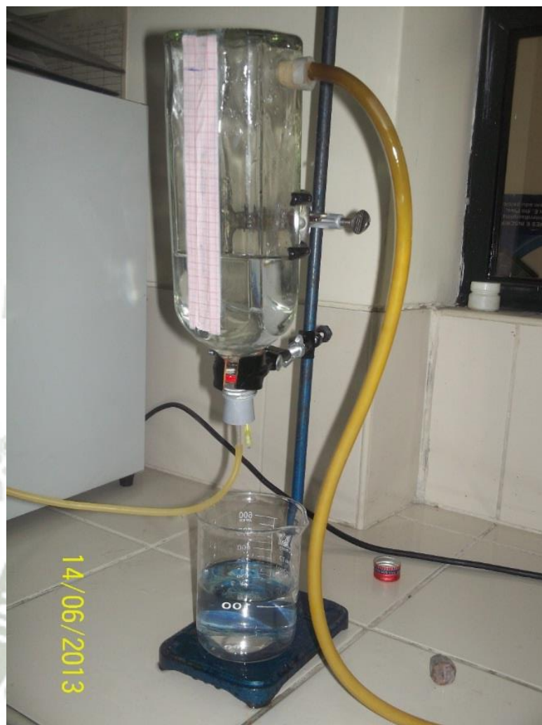
FIGURA N°12. Primera botella de Mariotte. Se observa el desplazamiento del líquido producido por el ingreso del biogás proveniente del bioreactor. Papel milimetrado para escalar el volumen de la botella.
