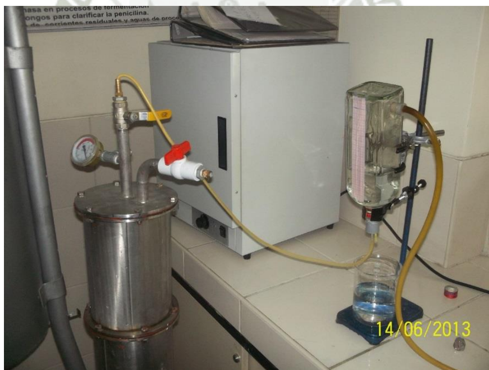
FIGURA N°11. Primera botella de Mariotte conectada al bioreactor para recolección de biogás y su medición. Se observa el papel milimetrado unido a la botella para escalar su volumen.
