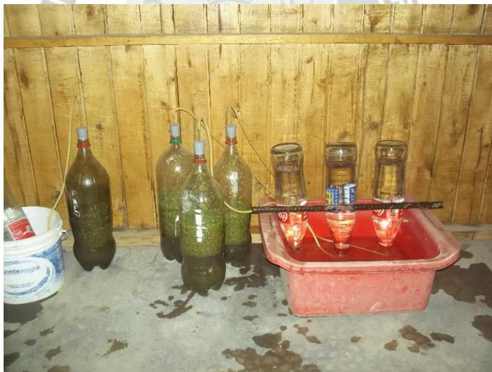
FIGURA N°6. Estimación de la producción diaria de biogás por el método de las botellas.
