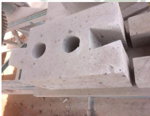
Imagen 56: Bloques encaje oblicuo alargado y reducido 40*20*15
