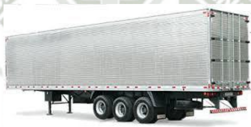
Figura 50. Semiremolque Furgón (Categoría O3 y Configuración S3)
