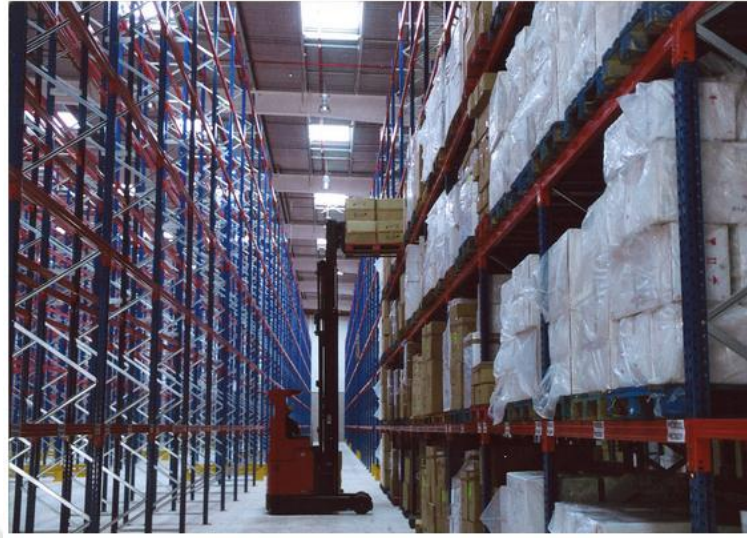
Figura 23. Almacenamiento con estanterías selectivas
