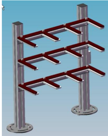
Figura 51 : Unidad de Almacenamiento
