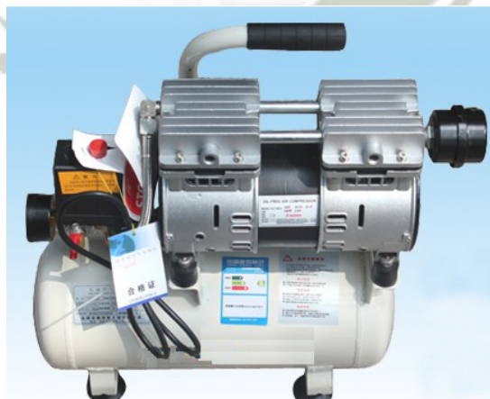
Figura 25: Alimentador de aire comprimido
