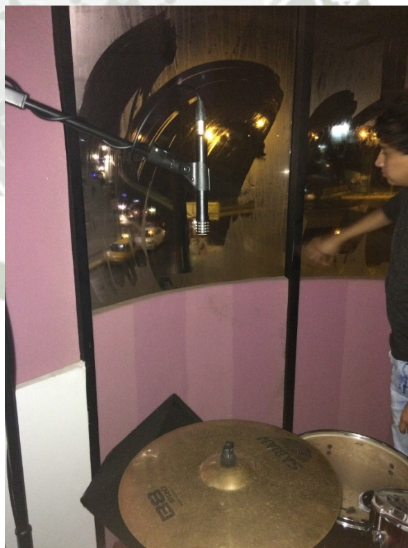
Figura 16. Colocación de micrófonos – Overhead L
