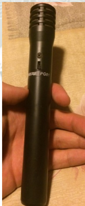
Figura 41. Shure PG81 – Micrófono escogido para platillos
