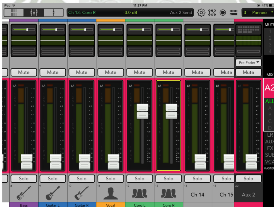
Figura 122. Configuración de la Mezcladora – Ruteo de coros a salida auxiliar 2 (vista A1)
