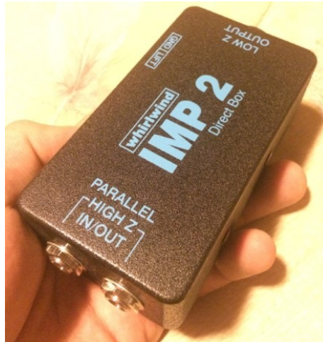
Figura 47. Whirlwind IMP 2 D.I. Box – Caja directa escogida para bajo eléctrico
