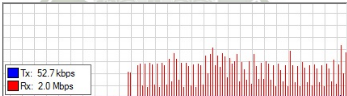
Figura 36. Tráfico local de datos generado por una cámara IP
