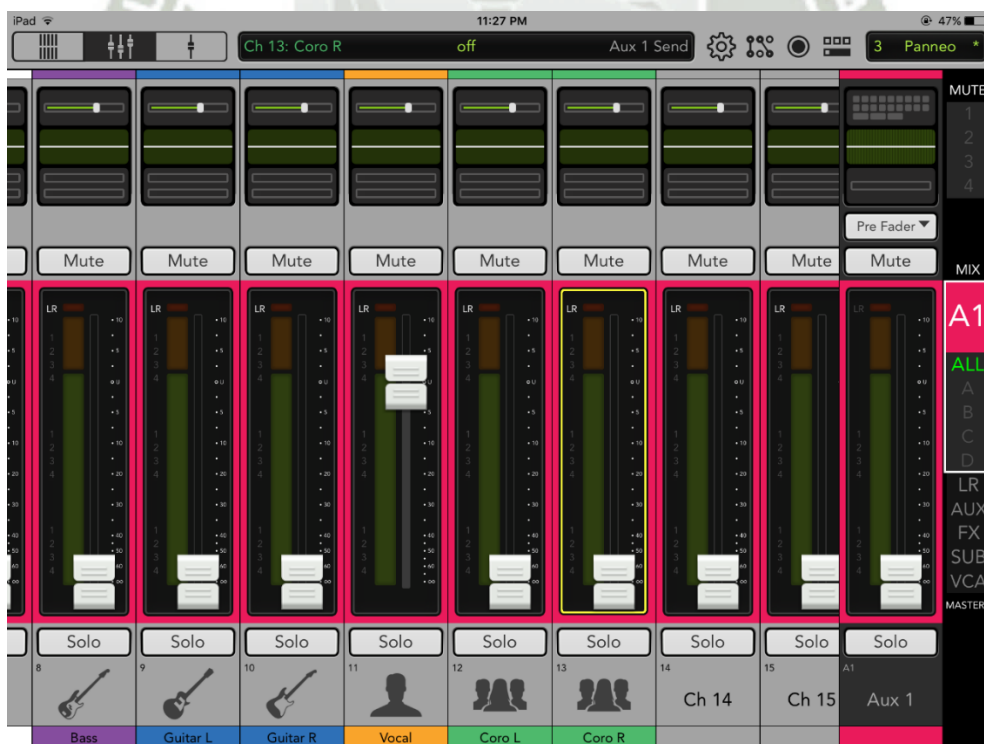
Figura 120. Configuración de la Mezcladora – Ruteo de voz líder a salida auxiliar 1 (vista A1)
