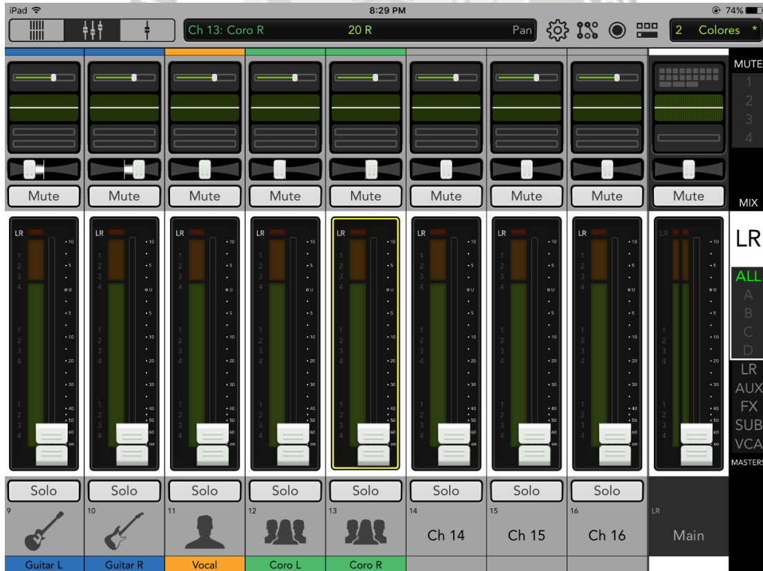
Figura 114. Configuración de la Mezcladora – Paneo de canales 9-13
