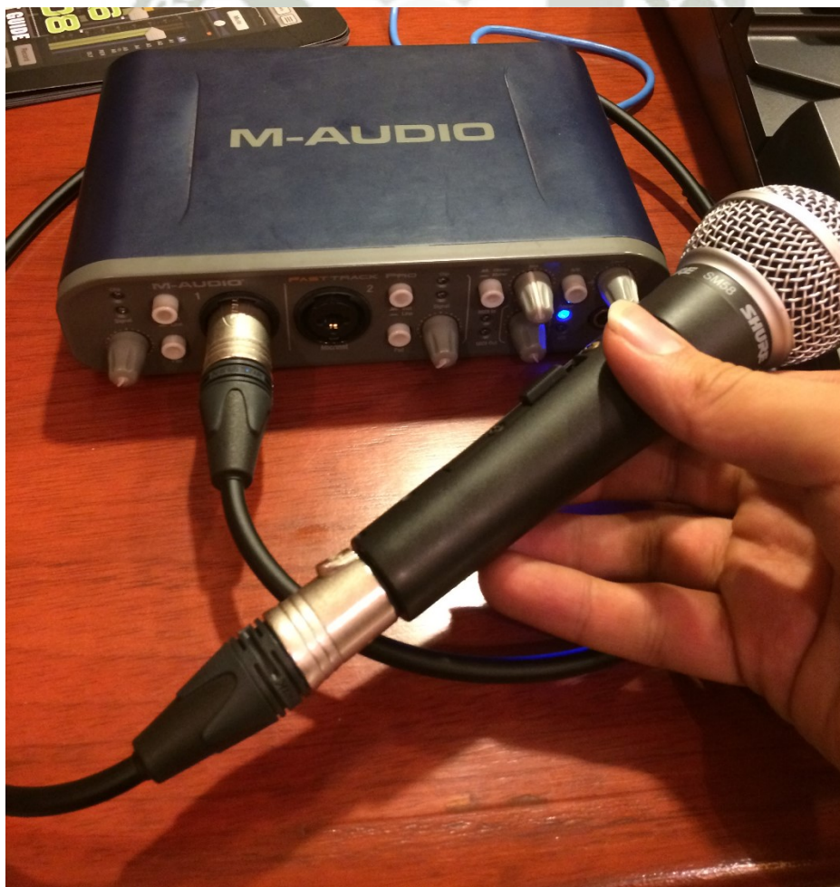
Figura 281. Interfaz de Audio Fast Track Pro – Conexión de micrófono a canal L
