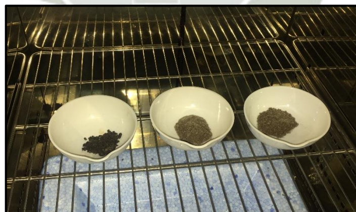
Figura 32. Determinación de humedad
