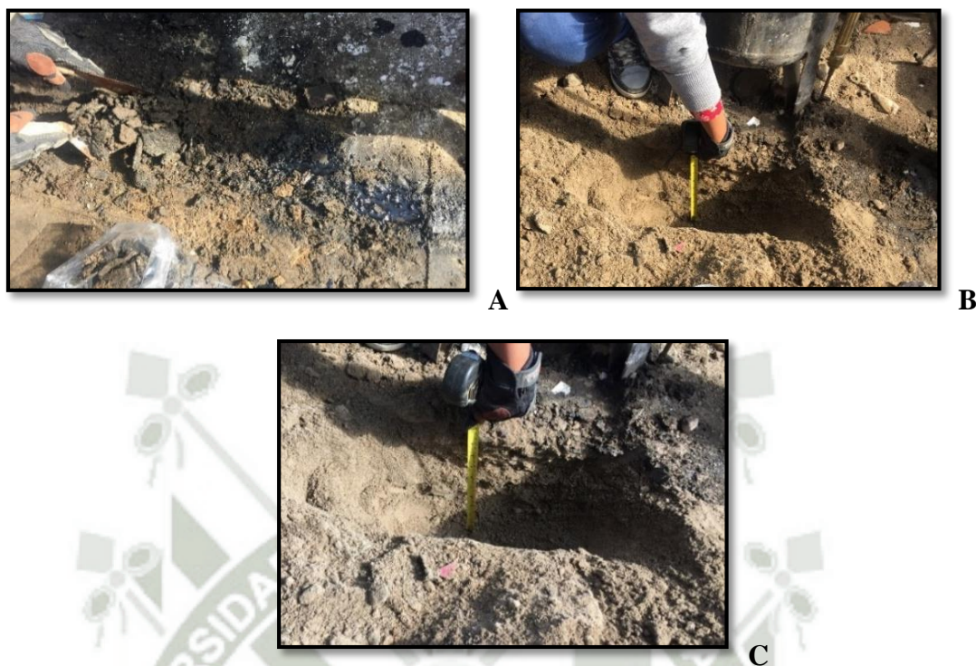
Figura 28. Divisiones de muestreo. A. Superficie: 0 cm; B. Medio: 15 cm de profundidad; C. Inferior: 30 cm de profundidad.
