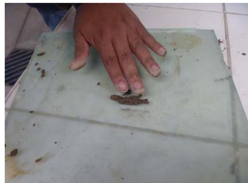
Foto 06: Ensayo de Limite Plastico
