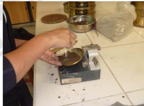
Foto 05: Ensayo Limite Plastico, cuchara Casa Grande
