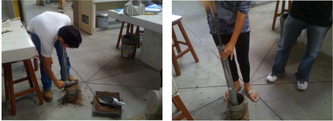
Foto 06: Ensayo de Compactación Proctor Modificado.
