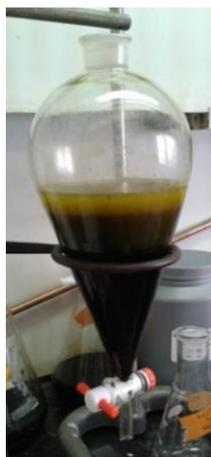
**Figura N°19:** Extracción utilizando Diclorometano
