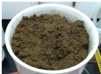
**Figura N°15:** Residuo obtenido posterior a la filtración al vacío
