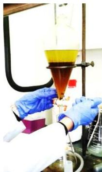
**Figura N°21:** Extracción con n-Butanol
