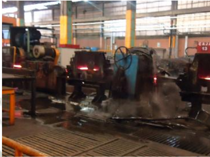
Fotografía 12 : Tren continuo de acabado Fuente: Elaboracion propia
