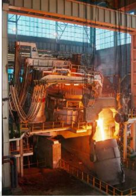
Fotografía 6: Fabricación del acero en horno eléctrico Fuente: Elaboración propia
