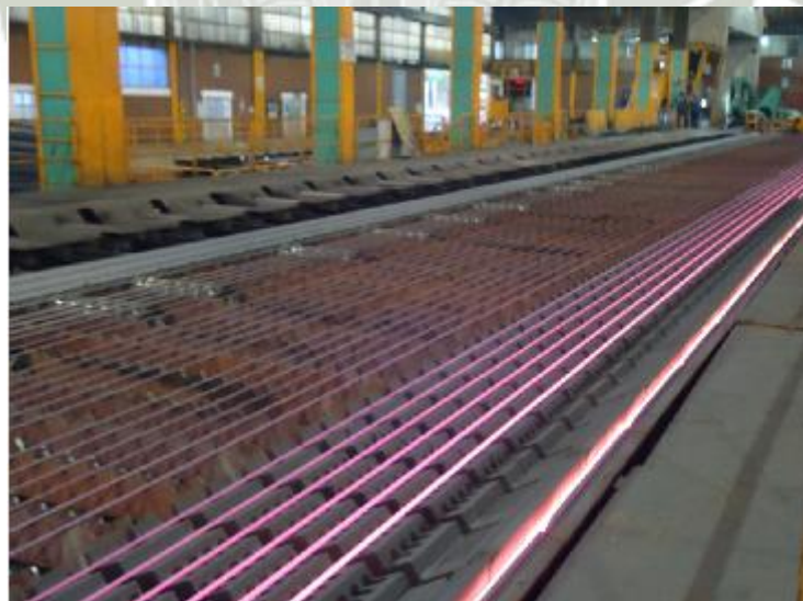
Fotografía 13 : Placa de enfriamiento Fuente: Elaboracion propia
