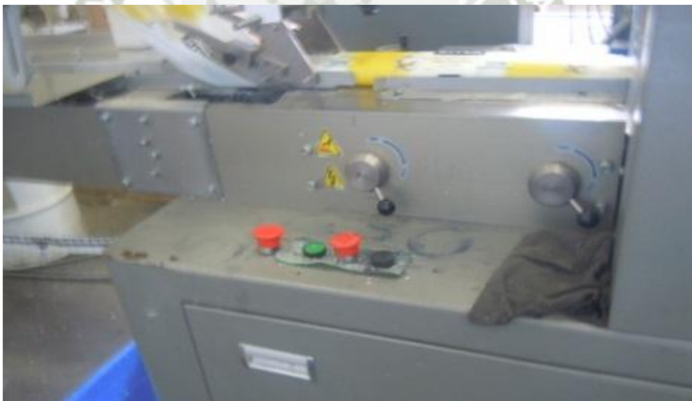
Imagen 8 Botoneras sin guardas en Planta Jabón
