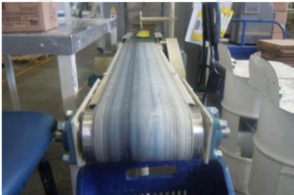
Imagen 6 Faja Transportadora Toma superior sin guardas en Planta Jabón
